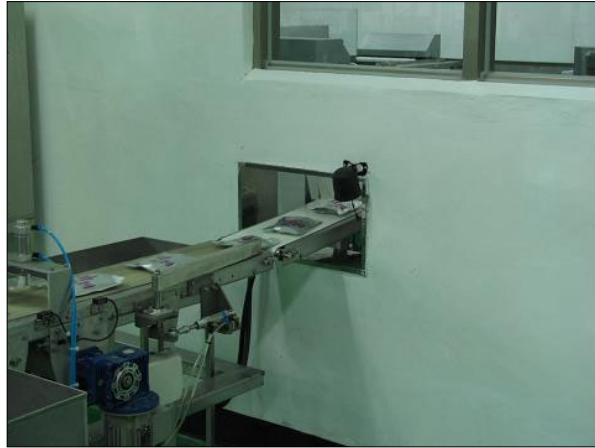
그림 21. 패스박스 설치 예(충전실에서 포장실로의 이동)
